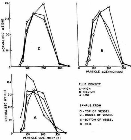
FIG. 4: PARTICLE SIZE DISTRIBUTION IN SLURRY SAMPLES FROM AGITATED VESSEL.
