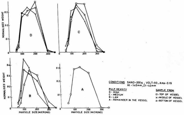
FIG. 3: PARTICLE SIZE DISTRIBUTION IN SLURRY SAMPLES FROM AGITATED VESSEL.
