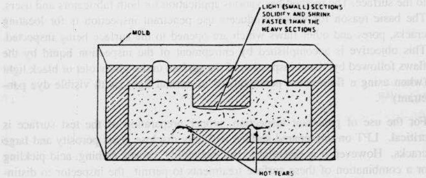
Fig. 4 : Shrink crack
